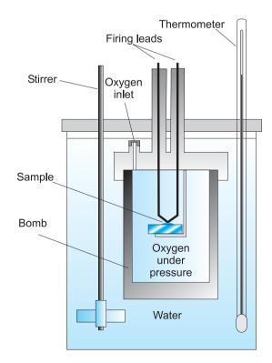
Fig. 6.7 Bomb calorimeter
